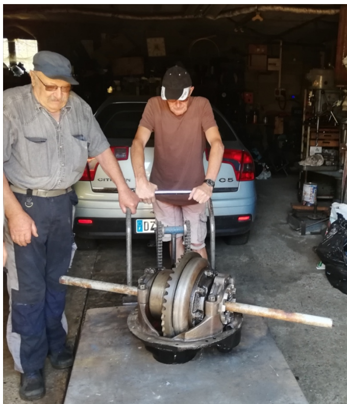
▲ - Les mécaniciens du musée, pour la plupart des "anciens" de l'usine d'Annonay, ont réparé la transmission de l'Isobloc 648 DP103.
