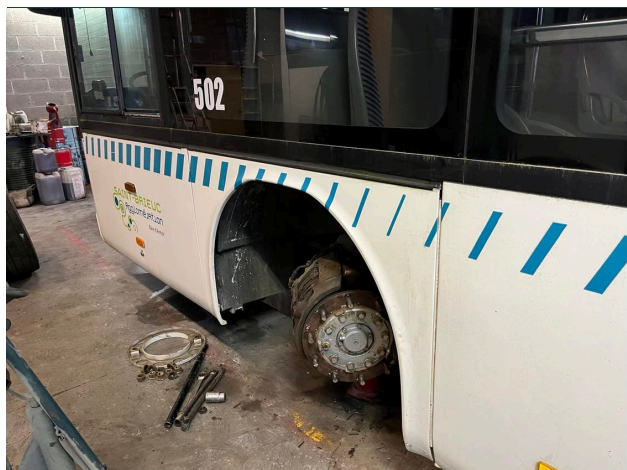
▲ - ... ou le remplacement de la barre de direction du S 315 NF.
