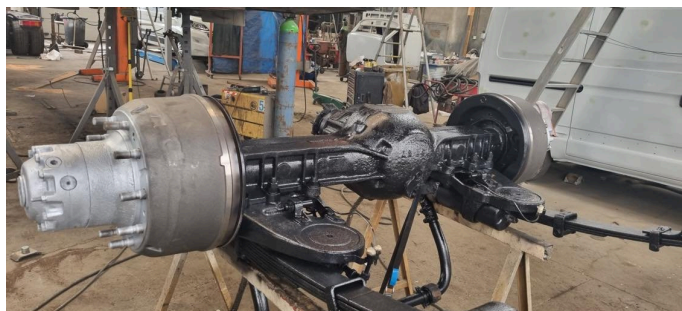
▲ - Chez HistoTUB, on ne craint pas les réparations lourdes telles que la restauration de l'essieu arrière du PR100.2 bus-théâtre...
