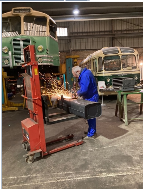
▲ - Aux ateliers du Musée, rendre les réservoirs de carburant étanches est un gros travail qui fait des étincelles !
