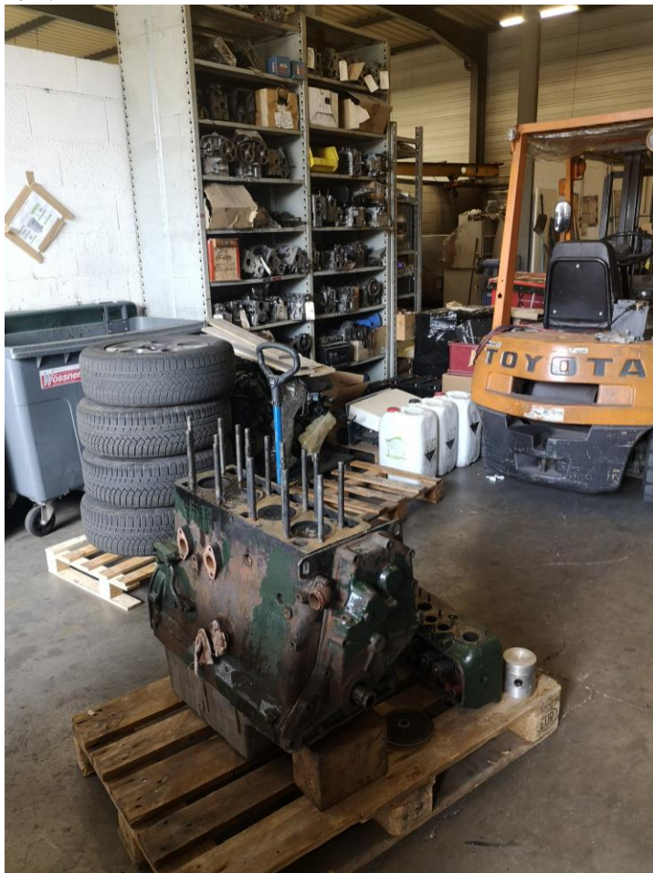
▲ - La dépose du moteur du Citroën 32. Si tout va bien, il pourra redémarrer dans les semaines à venir, après remise en état de ses parties malades - © Musée du Car
